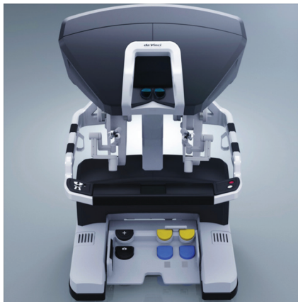
Figura 2. O console. O cirurgião controla cada movimento e ação do robô através de controles com as mãos e com os pés.
